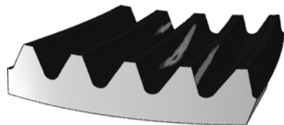
图17 大轮凸面接触压强
